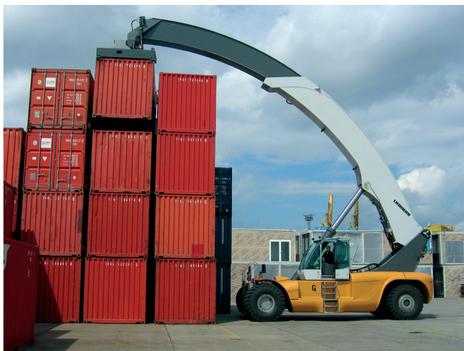
Figura 97. Reachstacker Liebherr de pluma telescópica curva
