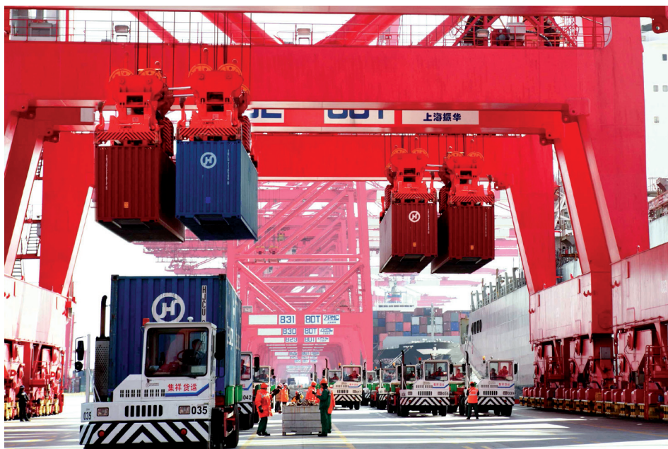
Figura 71. Grúas Dual Hoist Tandem (DHT40) de ZPMC
