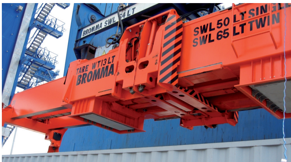
Figura 79. Spreader con escáner de radiación de Bromma
