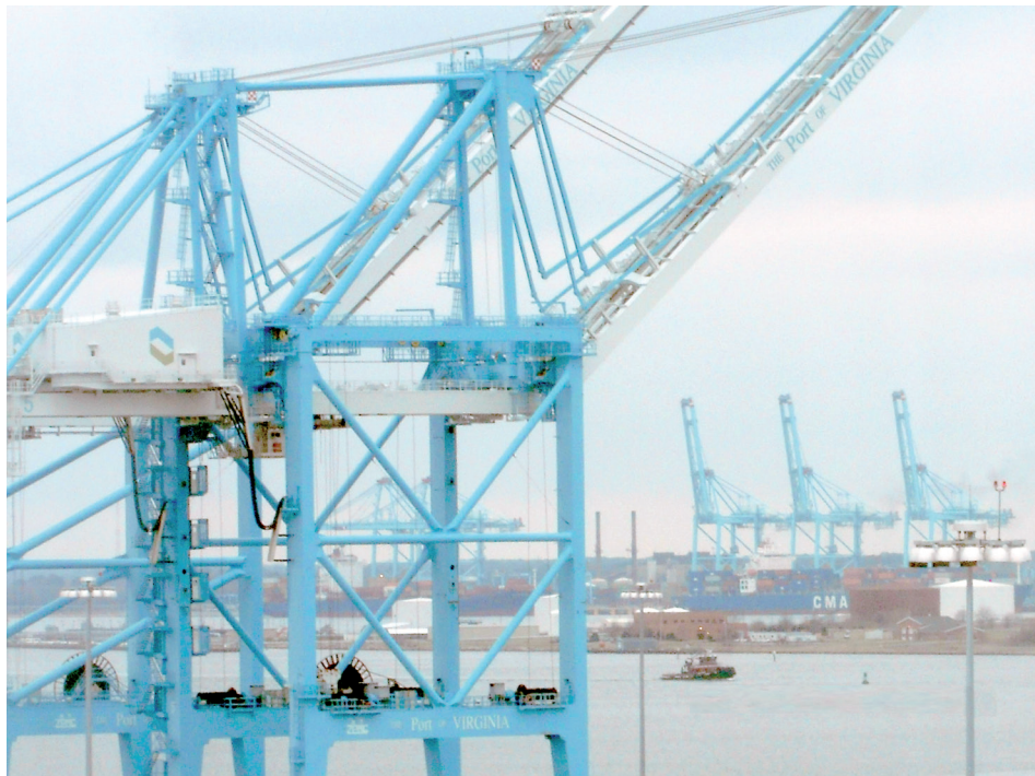
Figura 6o. Grúa con pluma ajustable en altura de ZPMC en APM Terminals Virginia (Port of Virginia – EE.UU.)
