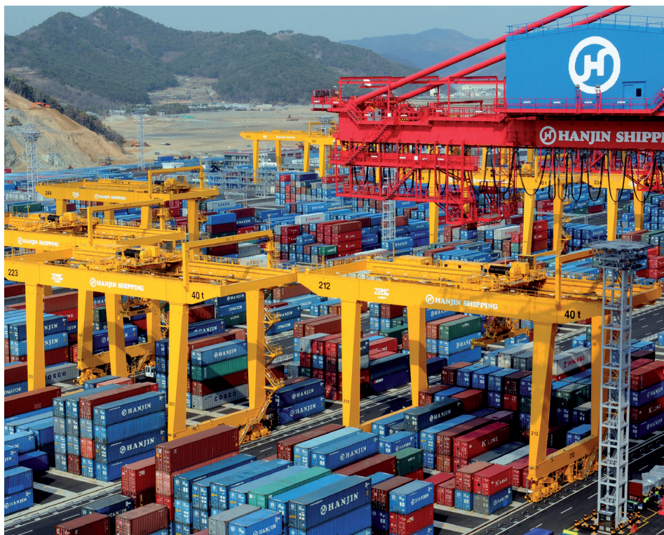
Figura 19. RMGs en Hanjin Terminal (Puerto de Busan – Corea del Sur)
