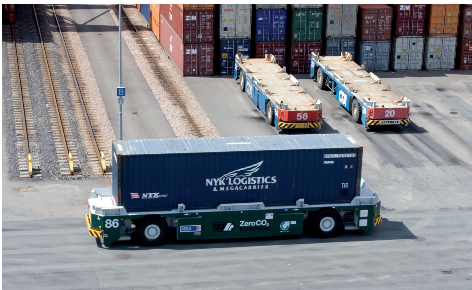
Figura 168. Battery AGV de Gottwald en HHLA CTA (Puerto de Hamburgo – Alemania)
