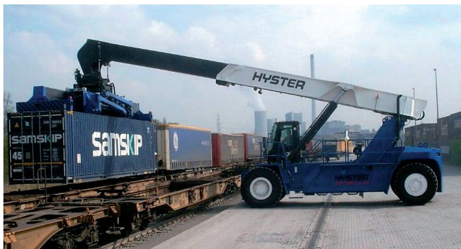
Figura 153. Reachstacker del fabricante Hyster
