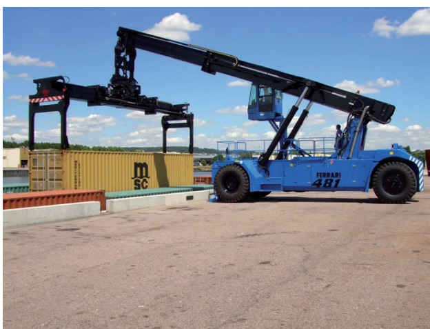
Figura 102. Reachstacker CVS Ferrari 481
