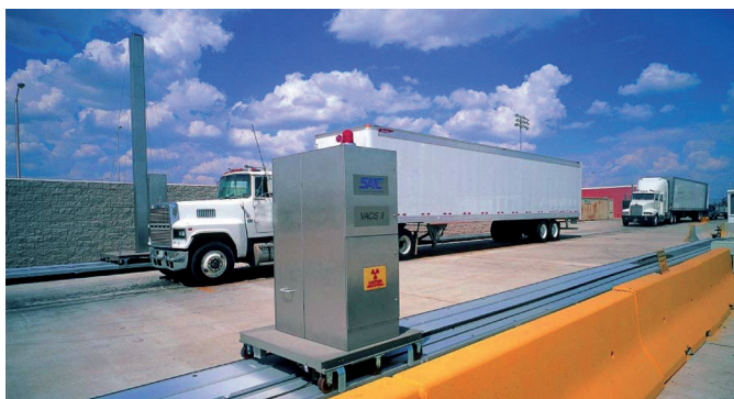
Figura 146. Sistema VACIS de escaneo reubicable
