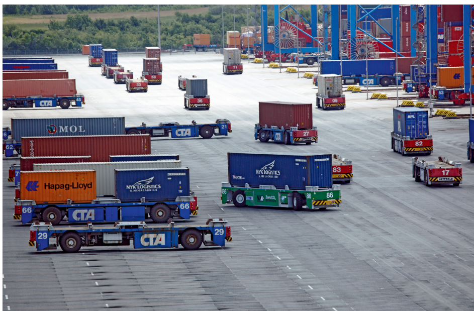
Figura 165. AGVs en HHLA CTA (Puerto de Hamburgo – Alemania)
