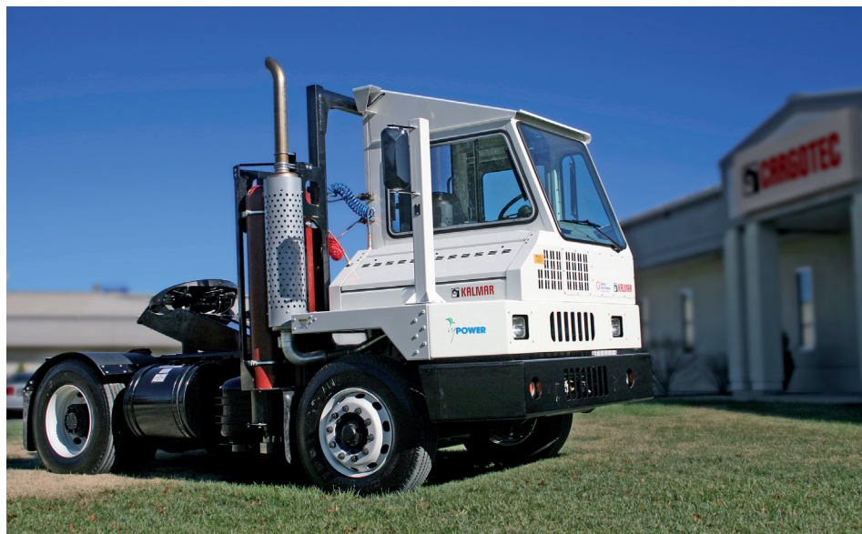
Figura 162. Cabeza tractora híbrida hidráulica Kalmar del grupo Cargotec
