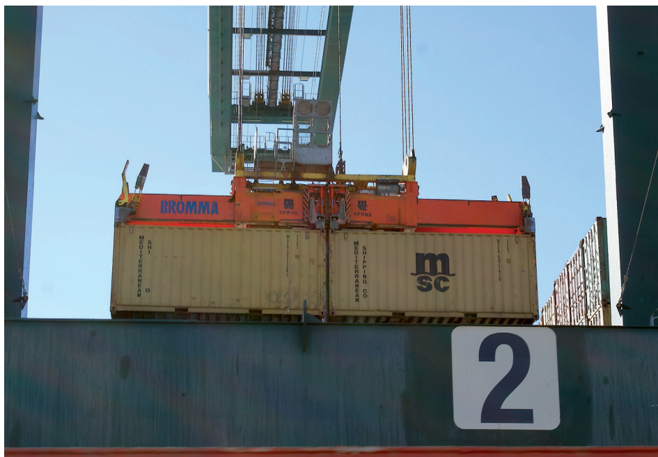
Figura 65. Dos contenedores de 20 pies izados mediante spreader twin-lift de Bromma
