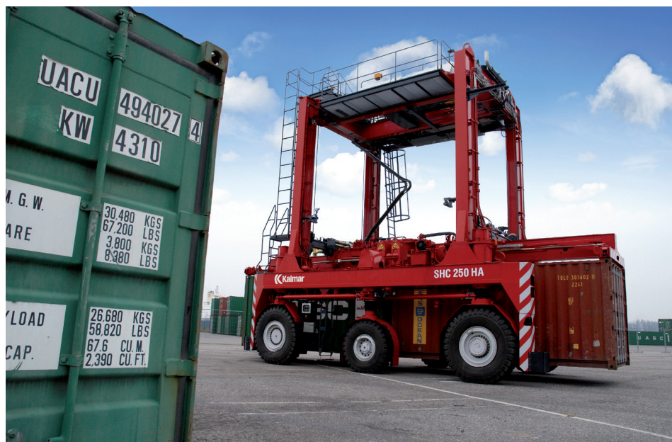
Figura 174. Mini SC de Kalmar automático. AutoShuttle Carrier
