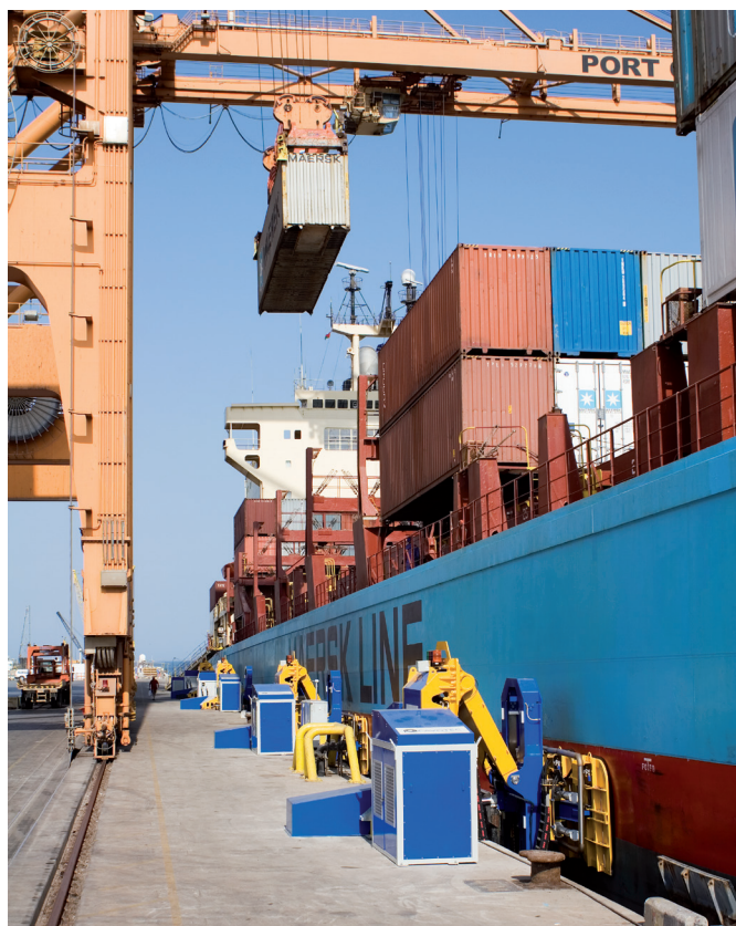
Figura 83. Sistema de autoamarre por vacío de Cavotec
