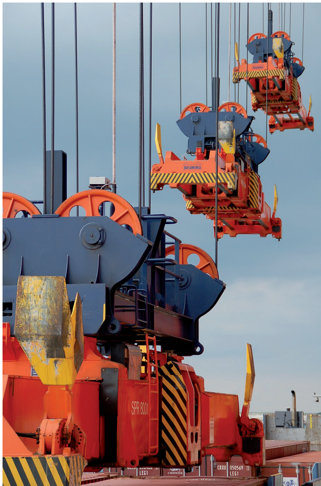
Figura 84. Detalle de spreaders eléctricos de Bromma
