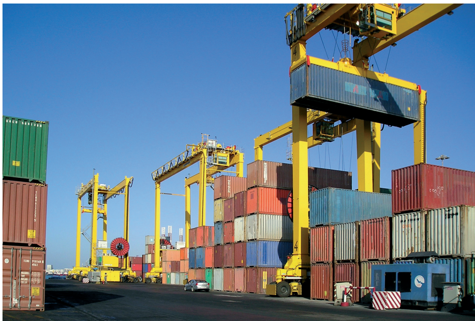
Figura 117. RTGs eléctricos en el Puerto de Sharjah – E.A.U.
