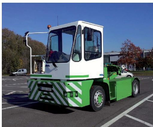
Figura 164. Versión europea de cabeza tractora eléctrica de Balqon-MOL
