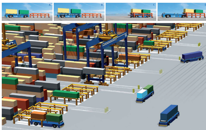
Figura 166. Esquema de la operación del Lift AGV en el patio de almacenamiento
