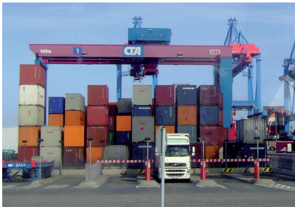
Figura 193. Recepción y entrega de camión con ASCs
