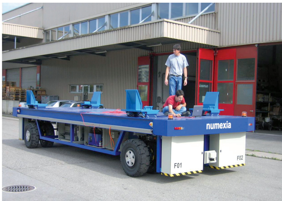
Figura 170. Prototipo de C-AGV propulsado por inducción eléctrica de TTS y Numexia
