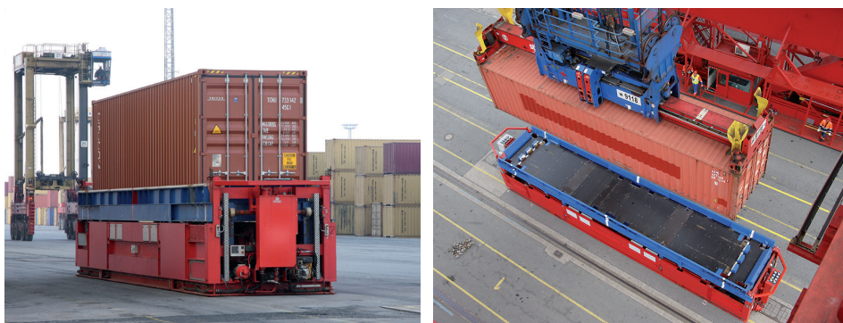
Figura 55. Sistema ALP de KALP Technology en operativa de descarga
