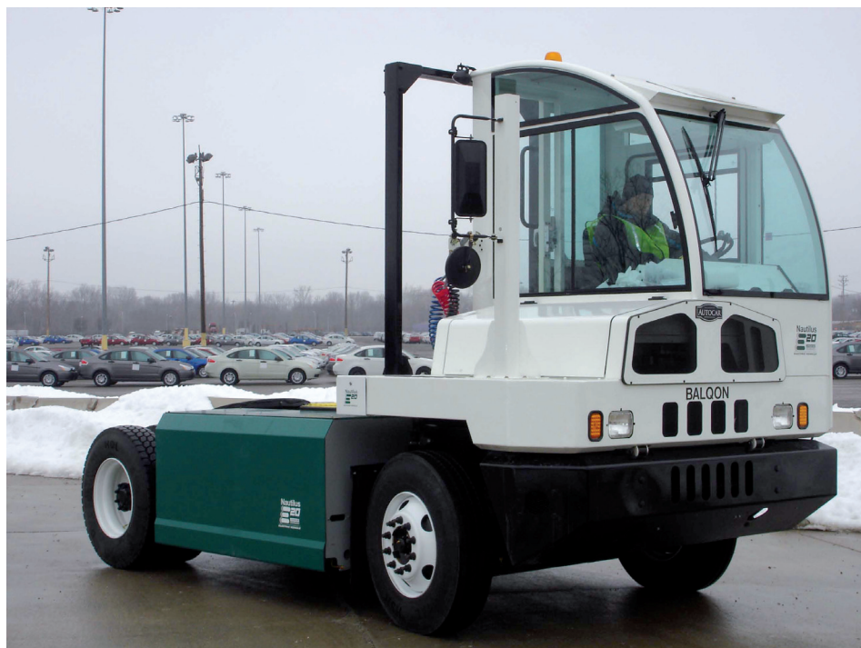
Figura 163. Cabeza tractora eléctrica de Balqon
