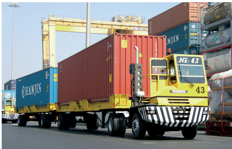
Figura 157. Sistema Multi-Tráiler de Buisear con cabeza tractora Terberg
