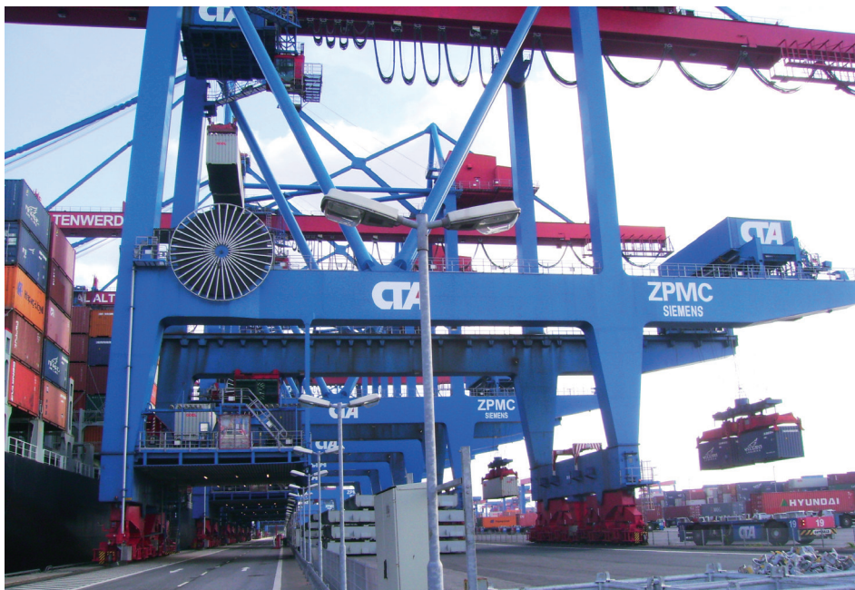
Figura 49. Operación de una grúa de doble trolley . Container Terminal Altenwerder (HHLA – CTA) (Puerto de Hamburgo – Alemania)
