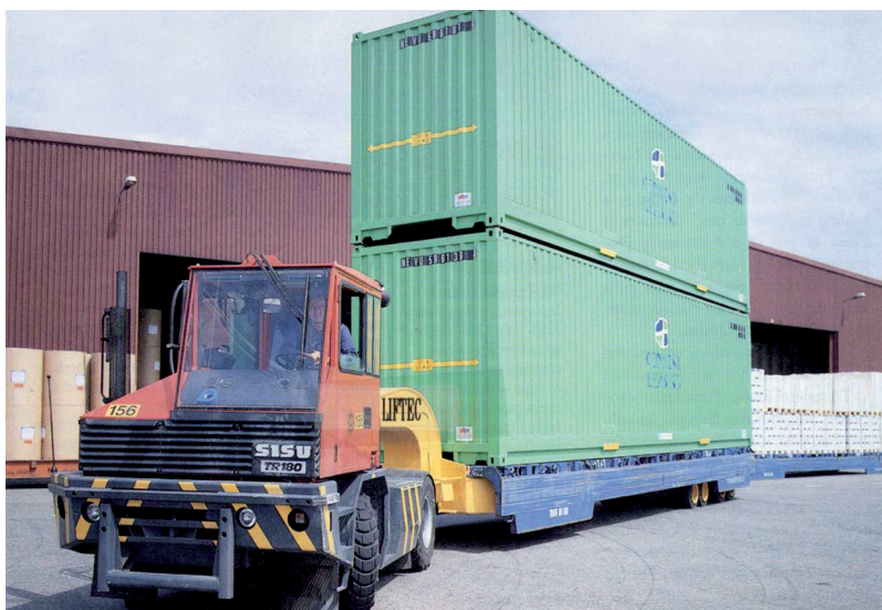
Figura 159. Sistema de plataforma autocargante de TTS
