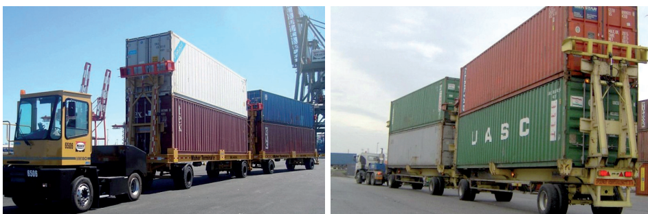
Figura 156. Plataformas de apilado a doble altura
