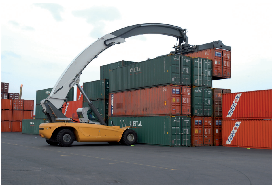
Figura 98. Alcance a tercera fila del reachstacker LRS de Liebherr
