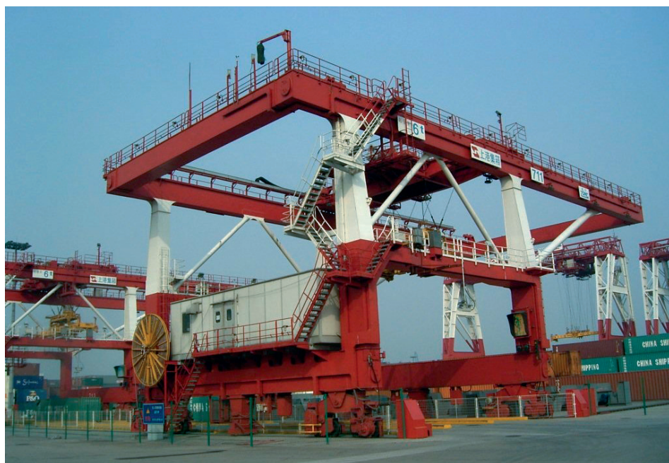
Figura 128. Sistema ASC para contenedores vacíos de la Terminal 5 Wai Quiaxiao (Puerto de Shanghai – China)
