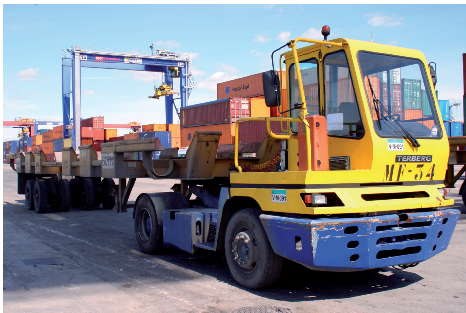
Figura 155. Cabeza tractora y plataforma
