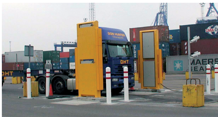
Figura 144. Portal de monitorización de radiación instalado en el Puerto de Felixstowe – Reino Unido
