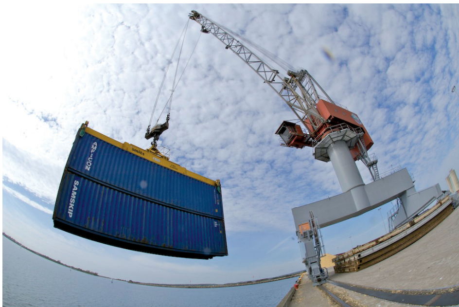
Figura 58. Operación Vertical Tandem Lift con twistlocks RAT
