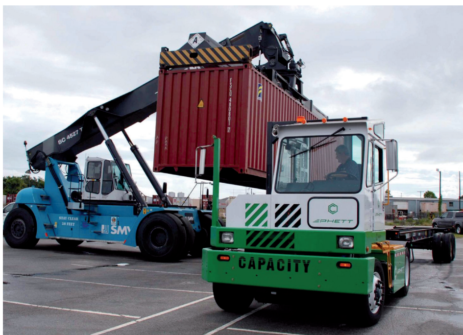
Figura 161. Cabeza tractora híbrida con sistema PHETT
