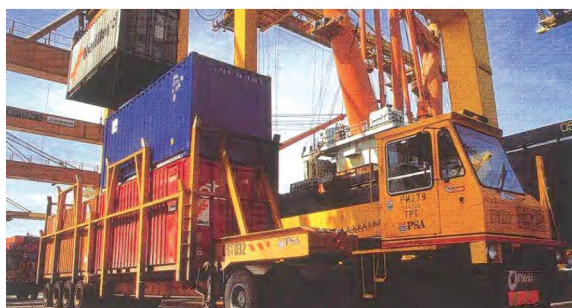
Figura 158. Plataforma de dos alturas en Tanjong Pagar Container Terminal. Puerto de Singapur
