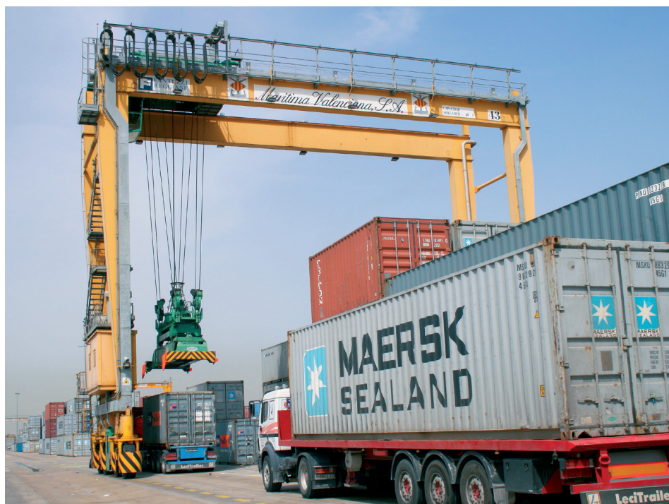
Figura 191. Recepción y entrega de camión con RTG
